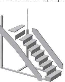
3. К основанию прикрепляют первую ступень с подступенью (поз. 8 и 9). Крепление металлического столба закрывается центральным столбом с отверстием и пазом (поз. 6)
