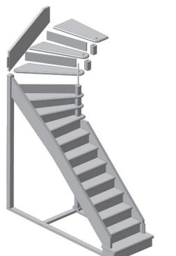
4. В пазы углового и центрального столбов заводят соответственно среднюю и нижнюю деревянную струны(поз. 10 и 11), закрепив их саморезами 3,5x70 мм.
