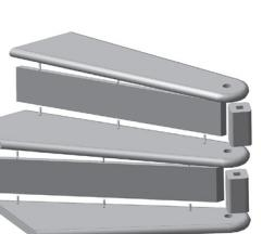
5. Между струнами металлическими уголками крепятся прямые ступени №2-8(поз. 12, 7 шт.). Устанавливаются подступени(поз. 13 и 14, всего 8 шт). Подступень №2 крепится с помощью шкантов 8x30 мм, последующие подступени крепятся к торцу ступеней с тыльной стороны саморезами 3,5x35 мм.
